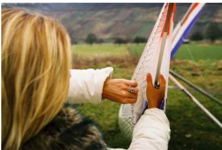
Die Demontage der Spreizlatte erfolgt auf umgekehrte Weise. ( Abbildung 6 )
